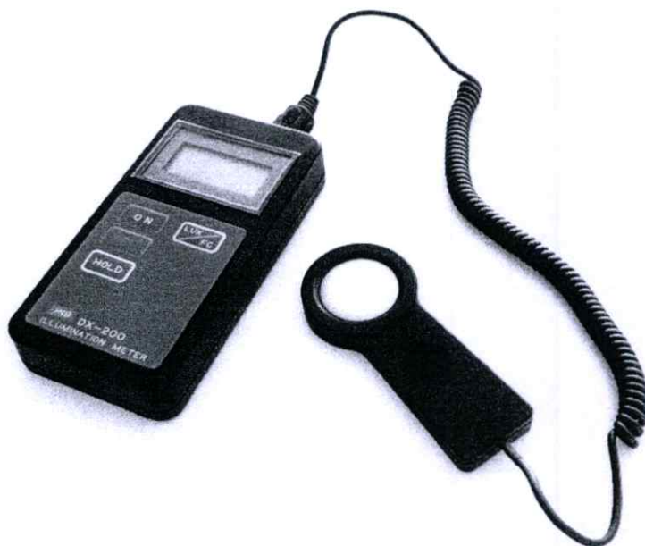
ภาพที่ 3.3 แสดงเครื่องวัดความส่องสว่างของแสงแบบตัวเลข (ILLUMINATION METER)
