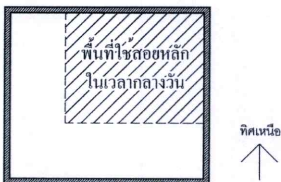
ภาพที่ 4.7 แสดงตัวอย่างผังอาคาร การจัดวางพื้นที่ใช้สอยหลักของบ้านในช่วงเวลากลางวัน หลักเฉียงตำแหน่งด้านทิศใต้และทิศตะวันตก และ/หรือ หลักเฉียงตำแหน่งชั้นบนของบ้าน
