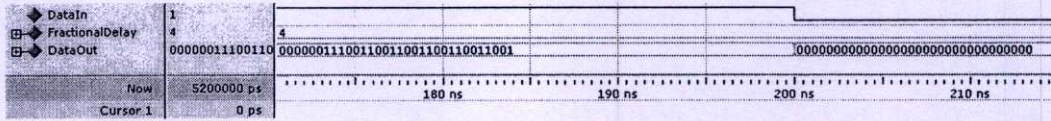
(ฉ) แผนผังเวลาการทำงานของตารางเปิดดูค่าการหน่วง ค่า 0.9
