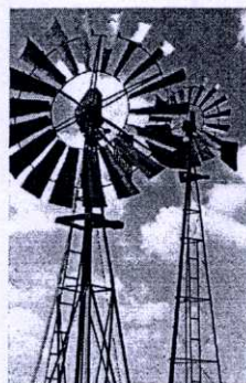
รูปที่ 2.26 ลักษณะกังหันลมแบบอเมริกันมัลติเบลด
