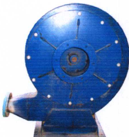
รูปที่ 4.6 Blower สำหรับเป็นแหล่งกำเนิดลมแก่ระบบ
