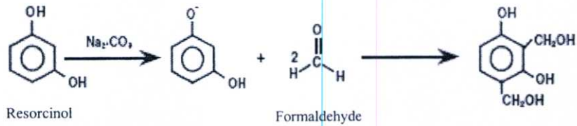
รูปที่ 2.2 ปฏิกิริยาการเติม (Addition reaction) [32]
