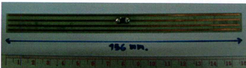
(ค) สายอากาศไดโพลกับเส้นปรสิคลำดับที่ 3
