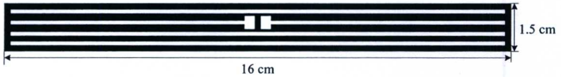
(ก) สายอากาศแท่งไคโพลกับเส้นปรสิติ
