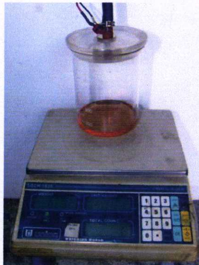
รูปที่ 3.42 การชั่งมวลของเชื้อเพลิง
