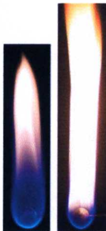
รูปที่ 1.5 ภาพถ่ายเปลวไฟของเบนซิน (ซ้าย) และ E30 (ขวา) ที่เส้นผ่านศูนย์กลางของวัสดุพอร์นเท่ากับ 8 มิลลิเมตร [10]
