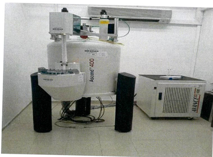
รูปที่ 3.4 เครื่องฟูเรียทรานสฟอร์ม นิวเคลียร์แมกเนติกเรโซแนนซ์ สเปกโตรโฟโตมิเตอร์
