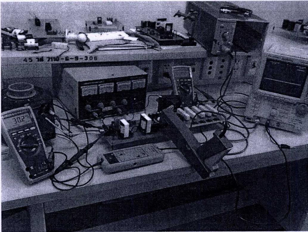
รูปที่ ก.1 ภาพถ่ายวงจร PFC ชุกคอนเวอเตอร์ ขณะทำการทดสอบ
