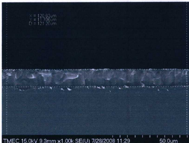
รูปที่ 5.10 ความหนาของชั้นพอร์สซิลิคอน โดยใช้ความหนาแน่นกระแสไฟฟ้า 25 \text{ mA/cm}^2
