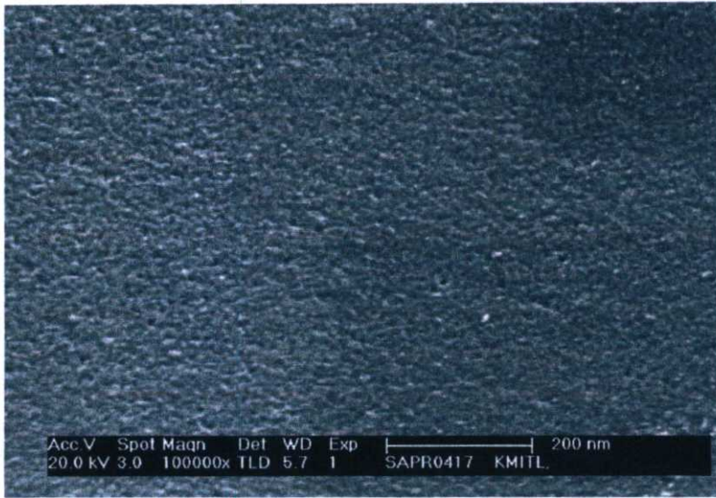
รูปที่ 2.11 ภาพพื้นผิวของชั้นพอร์สซิติคอนที่ได้จากกระบวนการแอโนไดซ์เซชัน
