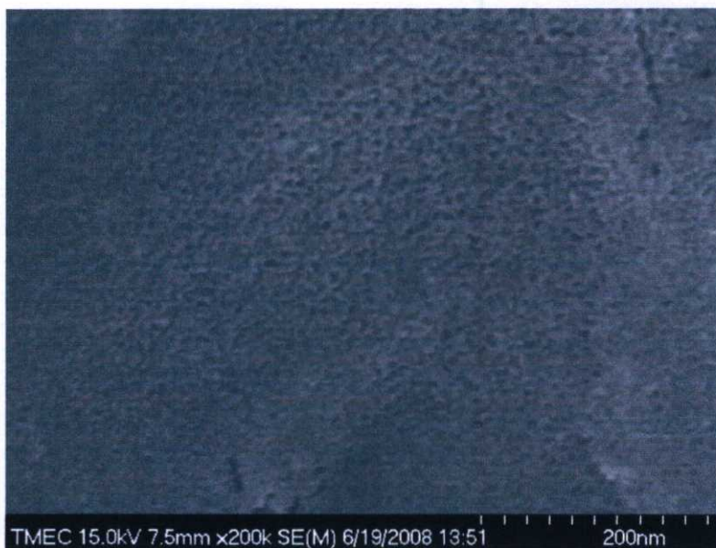
รูปที่ 5.2 ภาพพื้นผิวของชั้นพอร์สซิลิคอน โดยใช้ความหนาแน่นกระแสไฟฟ้า 10 mA/cm 2
