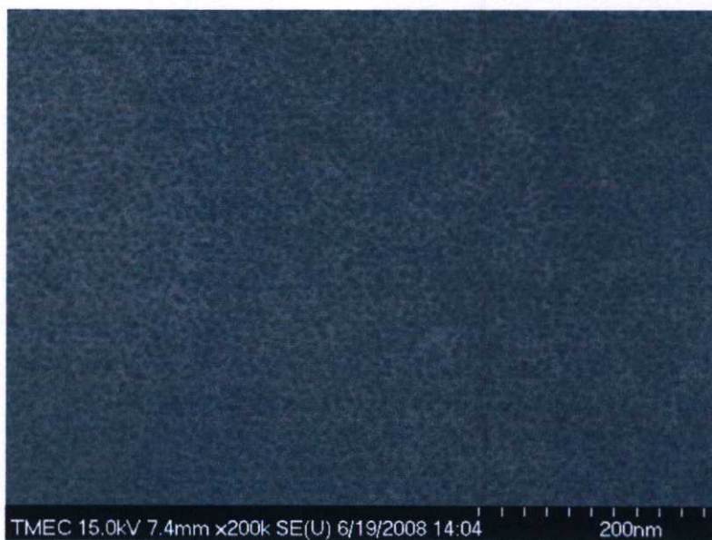
รูปที่ 5.3 ภาพพื้นผิวของชั้นพอร์สซิลิคอน โดยใช้ความหนาแน่นกระแสไฟฟ้า 15 mA/cm 2
