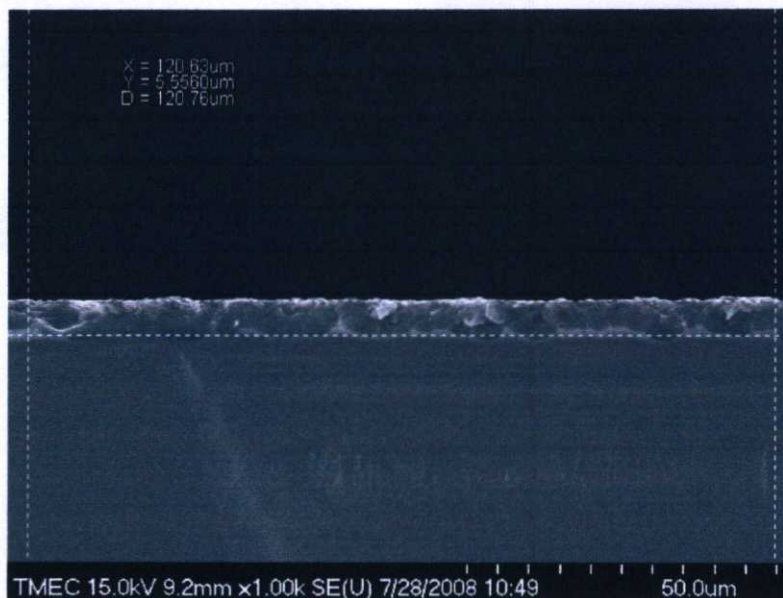
รูปที่ 5.16 ความหนาของชั้นพอร์ซซิลิคอน โดยใช้เวลาในการแอโนไดซ์เซชัน 10 นาที
