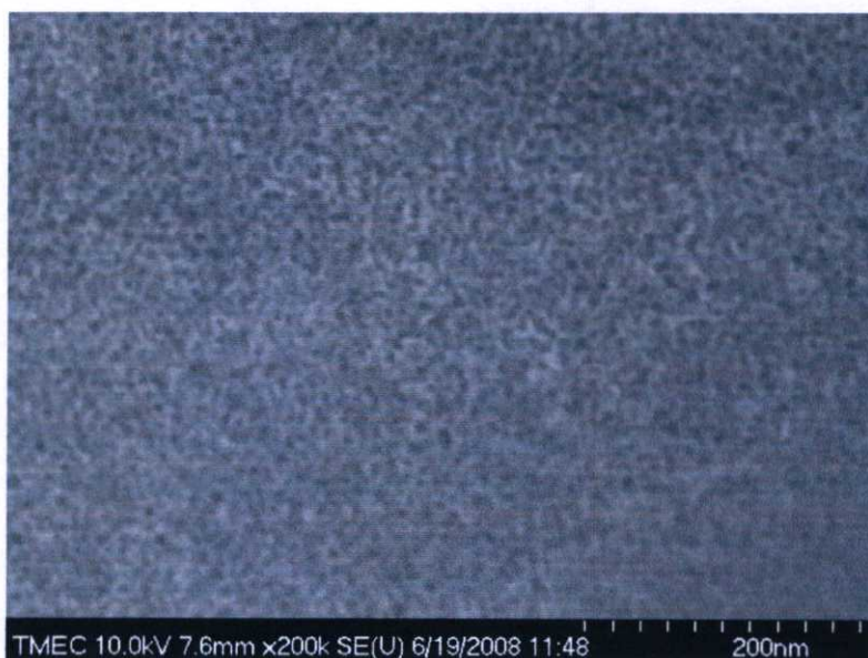
รูปที่ 5.5 ภาพพื้นผิวของชั้นพอร์สซิติคอน โดยใช้ความหนาแน่นกระแสไฟฟ้า 25 mA/cm 2
