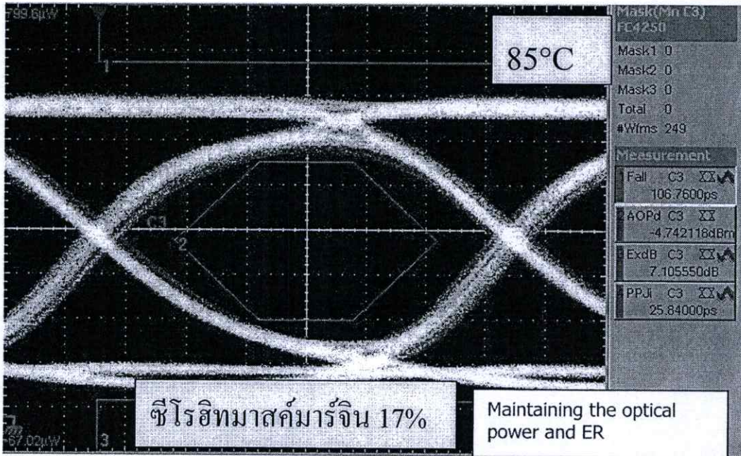
รูปที่ 2.17 ออปติกคอลอายโคอะแกรมที่ 85 องศาเซลเซียสด้วยวิธีคงค่ากำลังงานแสงและอัตราส่วนกำลังงานหลังจากทดสอบด้วยมาสค์ได้ค่าซีโรธิมาสค์มาร์จิน 17%
