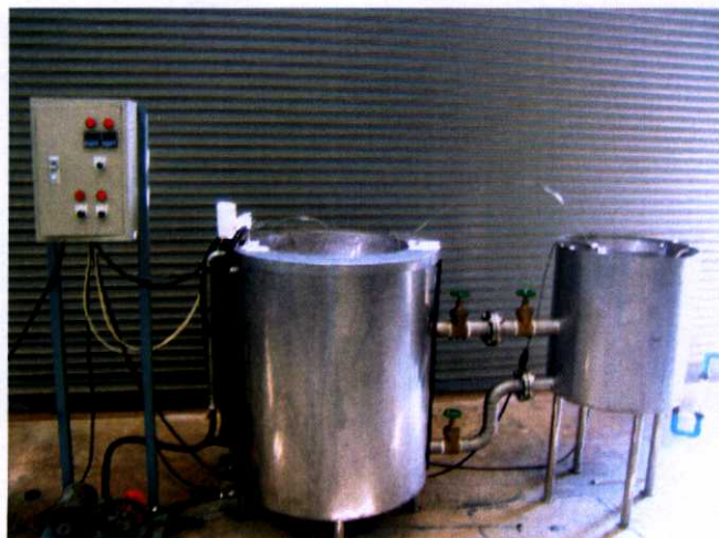
รูปที่ 4.14 เครื่องนํากลับสาร A702 แบบต่อเนื่อง มีอัตราการผลิตสูงสุดผลิต 200 ลิตร/ชั่วโมง (รูปถ่ายตอนที่ยังไม่ได้หุ้มฉนวนกันความร้อน)
