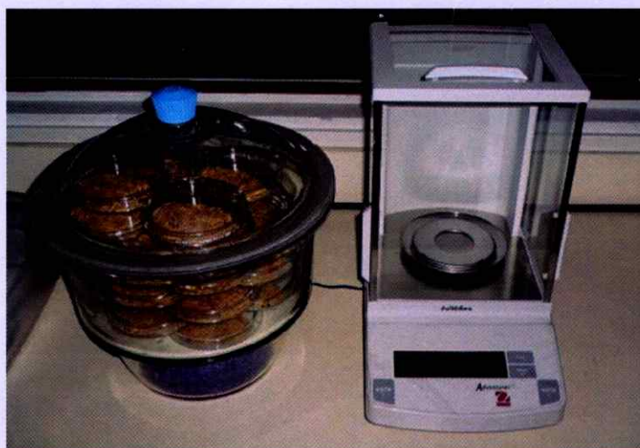
รูปที่ ผ1 ตัวอย่างข้าวเปลือกในหม้อที่บรรจุสารดูดความชื้นและเครื่องชั่งน้ำหนักที่มีความละเอียดระดับ 0.0001 กรัม
