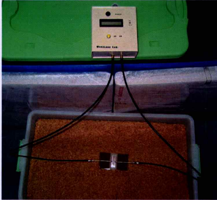
รูปที่ 5.13 การวัดทดสอบข้าวเปลือกด้วยระบบเครื่องมือที่นำเสนอ
