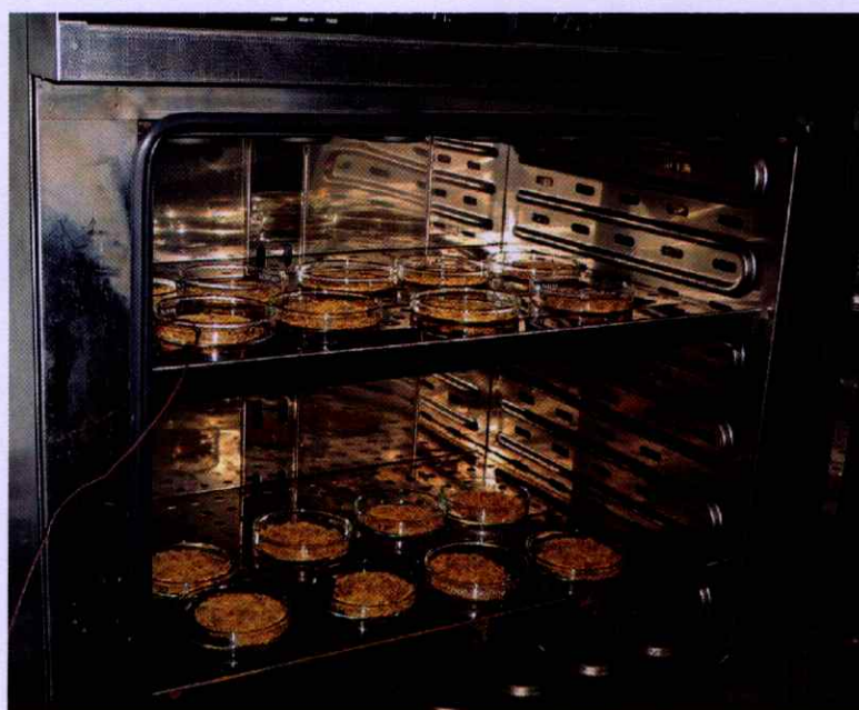
รูปที่ ผ2 ตัวอย่างข้าวเปลือกที่เข้าเตาอบลมร้อนเพื่อลดความชื้น
