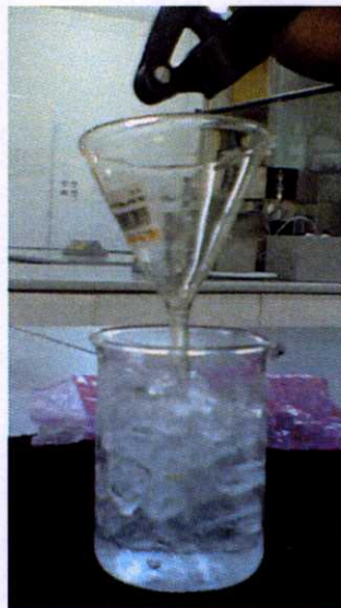
ภาพที่ 3.12 อุปกรณ์การสกัดน้ำมันหอมระเหยด้วยวิธีบีบเย็น
