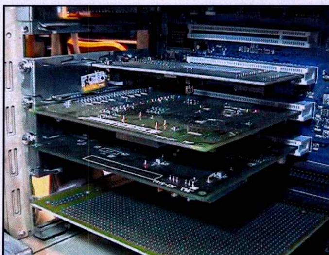
รูปที่ ก.3 การติดตั้งแผ่นวงจรเชื่อมต่อ รหัส PCI-6201E และรหัส PCI-3345A
