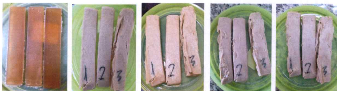
รูปที่ 4.26 ปริมาณการดูดซับน้ำของพอลิเมอร์ผสมระหว่าง TPCS70/LDPE30/C10
