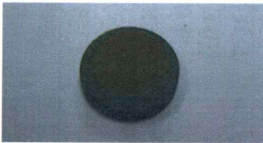
รูปที่ 4.1 แสดงสิ่งประดิษฐ์ของรอยต่อวิวิธพันธุ์ของสารกึ่งตัวนำ n-CdS/CuAlO 2 ซึ่งเตรียมโดยวิธีการระเหยสารเคมีด้วยความร้อนในระบบสุญญากาศเมื่อทำการแอนนัลภายใต้บรรยากาศของแก๊สไนโตรเจนบริสุทธิ์ที่อุณหภูมิ 400 องศาเซลเซียส เป็นเวลา 30 นาที
