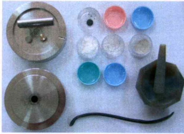
รูปที่ 3.1 แสดงอุปกรณ์ที่ใช้ในการเตรียมเม็ดเซรามิกของสารกึ่งตัวนำ \text{CuAlO}_2 จากสารตั้งต้นที่เป็นผงผลึก โดยวิธีปฏิกิริยาสถานะของแข็ง
