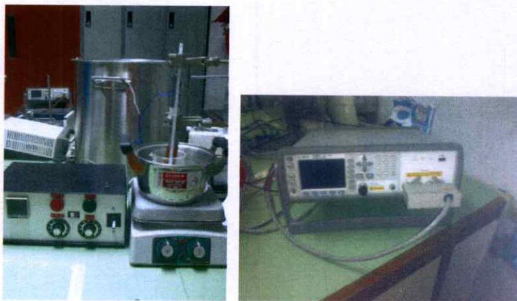
รูปที่ 3.3 แสดงอุปกรณ์ที่ใช้ศึกษาสมบัติเฉพาะของไดโอดด้วยการวัด ค่าความจุไฟฟ้ากับความถี่ และอิมพีแดนซ์สเปกโตรสโคปีโดยการวัดความสัมพันธ์ระหว่างอิมพีแดนซ์เชิงซ้อนกับความถี่ที่อุณหภูมิในช่วง 25 ถึง 80 องศาเซลเซียส
