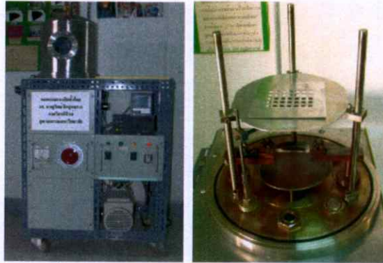
รูปที่ 3.2 แสดงอุปกรณ์ที่ใช้ในการเตรียมไดโอดของสารกึ่งตัวนำ \text{CdS/CuAlO}_2 ตามลำดับ โดยการเคลือบฟิล์มบางของสารกึ่งตัวนำ \text{CdS} ลงบนแผ่นฐานรองรับที่เป็นเม็คเซรามิกของสารกึ่งตัวนำ \text{CuAlO}_2 โดยวิธีการระเหยสารเคมีด้วยความร้อนในระบบสุญญากาศโดยการให้อุณหภูมิแก่แผ่นฐานรองรับประมาณ 100 องศาเซลเซียส
