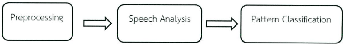
รูปที่ 3.4 ขั้นตอนหลักในการดำเนินการรู้จำเสียง
