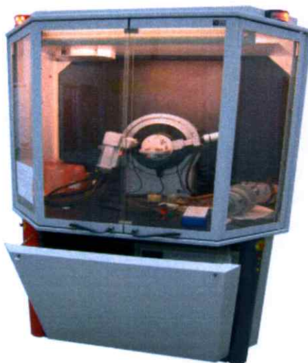
รูปที่ 3.5 แสดงเครื่องเอกซเรย์ดิฟแฟรคโตมิเตอร์ยี่ห้อ Bruker รุ่น D8 advance
