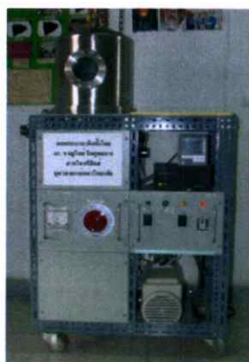
รูปที่ 3.8 แสดงอุปกรณ์ที่ใช้ในการเตรียมไดโอดของสารกึ่งตัวนำ n-CdS/p-CuO ตามลำดับ โดยการเคลือบฟิล์มบางของสารกึ่งตัวนำ CdS ลงบนแผ่นฐานรองรับที่เป็นกระจกสไลด์และที่เป็นเม็ดเซรามิกของสารกึ่งตัวนำ CuO โดยวิธีการระเหยสารเคมีด้วยความร้อนในระบบสุญญากาศโดยการให้อุณหภูมิแก่แผ่นฐานรองรับประมาณ 100 องศาเซลเซียส
