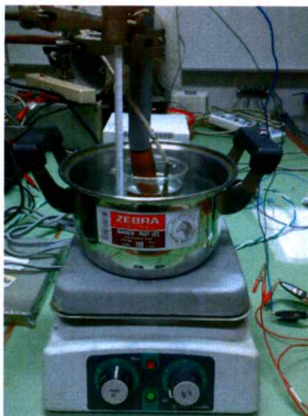
รูปที่ 3.12 แสดงอุปกรณ์ที่ใช้ในการควบคุมอุณหภูมิในช่วง 25 – 90 องศาเซลเซียส เพื่อศึกษาสมบัติเฉพาะของไดโอดด้วยการวัดกราฟความสัมพันธ์ระหว่างค่าความจุไฟฟ้ากับความถี่ และการวัดอิมพีแดนซ์สเปกโตรสโคปี
