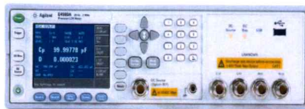
รูปที่ 3.11 แสดงอุปกรณ์ที่ใช้ศึกษาสมบัติเฉพาะของไดโอดด้วยการวัดความสัมพันธ์ระหว่างค่าความจุไฟฟ้า-แรงดันไฟฟ้า (C-V curve) และอิมพีแดนซ์สเปกโตรสโคปีที่อุณหภูมิต่างๆ ในช่วง 20-300 เคลวิน
