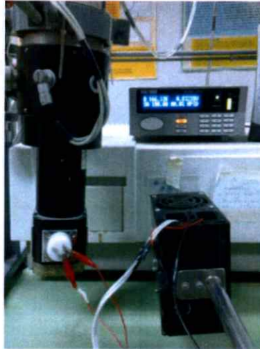
รูปที่ 3.10 แสดงภาพถ่ายของไดโอดแอดดที่ใช้ศึกษาสมบัติเฉพาะของไดโอดด้วยการวัดกราฟความสัมพันธ์ระหว่างค่ากระแสไฟฟ้า-แรงดันไฟฟ้า (I-V curve) ที่อุณหภูมิต่างๆ ในช่วง 20-300 เคลวิน
