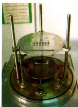
รูปที่ 3.8 แสดงอุปกรณ์ที่ใช้ในการเตรียมไดโอดของสารกึ่งตัวนำ n-CdS/p-CuO ตามลำดับ โดยการเคลือบฟิล์มบางของสารกึ่งตัวนำ CdS ลงบนแผ่นฐานรองรับที่เป็นกระจกสไลด์และที่เป็นเม็ดเซรามิกของสารกึ่งตัวนำ CuO โดยวิธีการระเหยสารเคมีด้วยความร้อนในระบบสุญญากาศโดยการให้อุณหภูมิแก่แผ่นฐานรองรับประมาณ 100 องศาเซลเซียส
