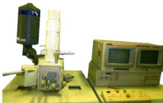
รูปที่ 3.6 แสดงกล้องจุลทรรศน์อิเล็กตรอนแบบส่องกราด ยี่ห้อ JEOL รุ่น JSM-5410LV
