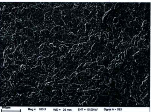
รูปที่ 4.32 สัณฐานวิทยาแสดงภาคตัดขวางของพอลิเมอร์ผสมระหว่าง LDPE และ TPMBs ที่ปรับปรุงสมบัติด้วยคาร์ราจีแนนในปริมาณ 0.2, 6 และ 10 % โดยน้ำหนัก ที่กำลังขยาย 100 เท่า [(ก) (ค) (จ) และ (ช)] และ 300 เท่า [(ข) (ง) (ฉ) และ (ซ)]
