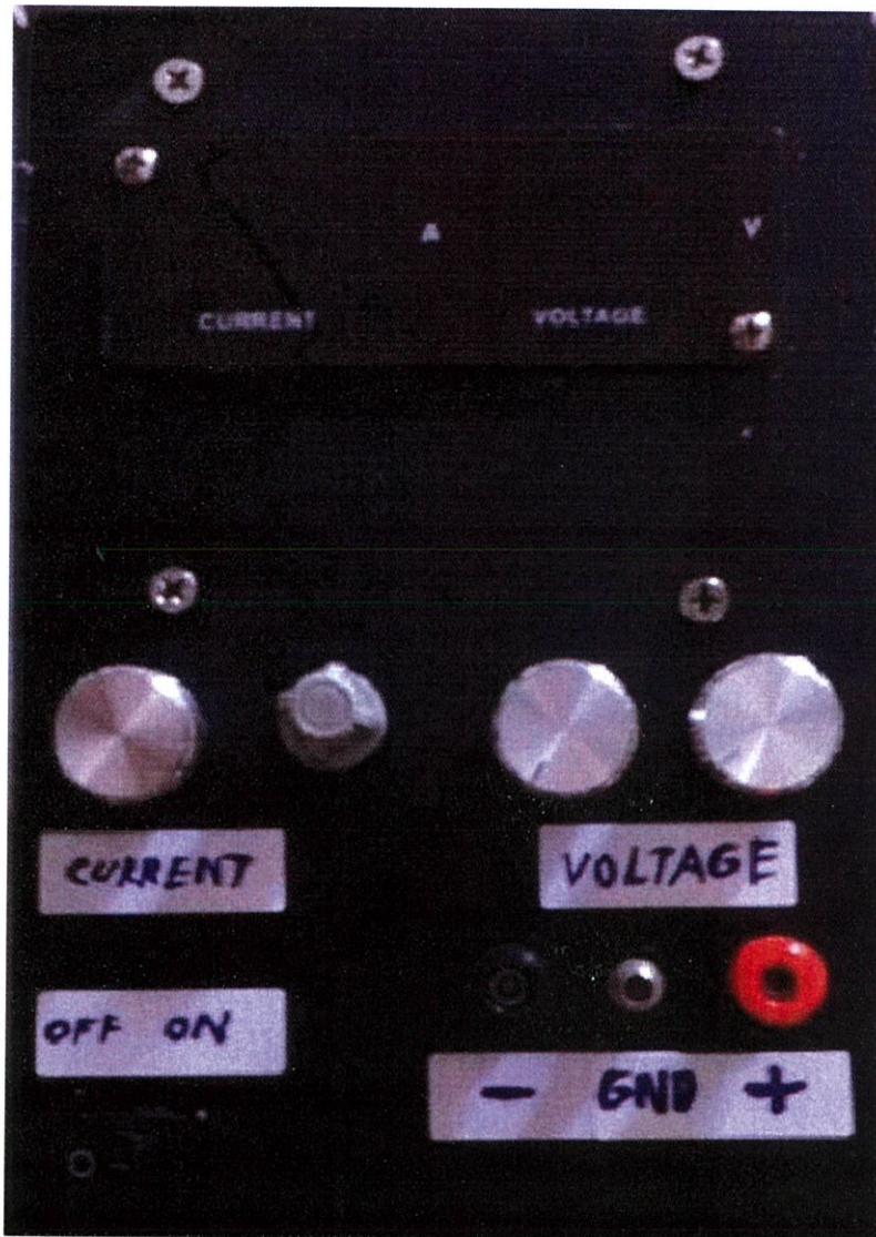
รูปที่ 3.27 พาวเวอร์ซัพพลายที่เสร็จสมบูรณ์
