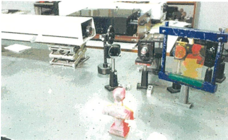
รูปที่ 2.16 ระบบ He-Ne Laser (กล่องสีขาว) ที่ใช้ในการสร้างภาพโฮโลแกรม
