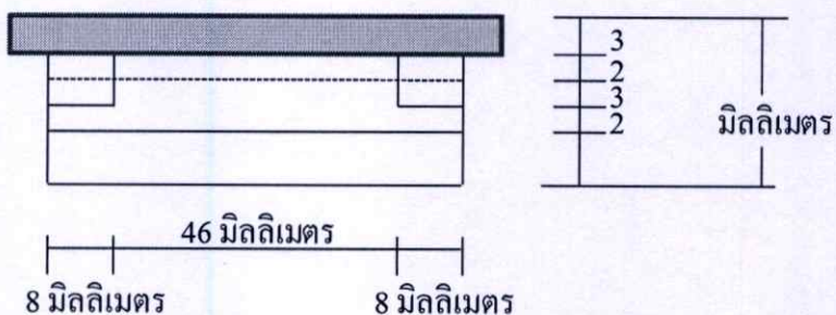
รูปที่ 3.5 แสดงขนาดของ MGD unit แบบที่สอง
