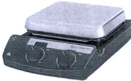
รูปที่ 2.11 เครื่องกวนสารละลายชนิดแม่เหล็กพร้อมให้ความร้อน
