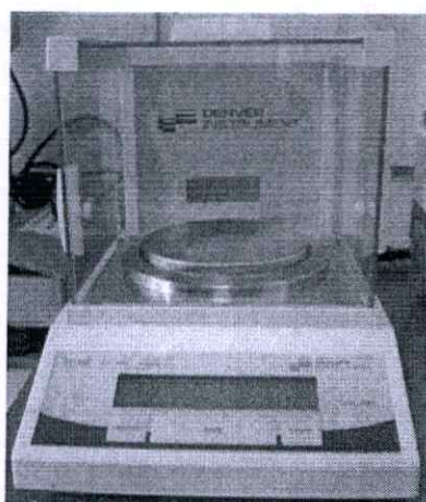
รูปที่ 3.1 เครื่องชั่งสารแบบละเอียดทศนิยม 3 ตำแหน่ง
