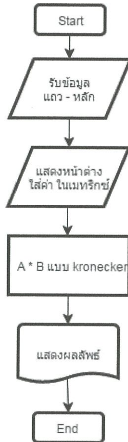
รูปที่ 3.2 แผนผังการทำงานผลคูณเมทริกซ์แบบโครเนเคเคอร์ (Kronecker product)
