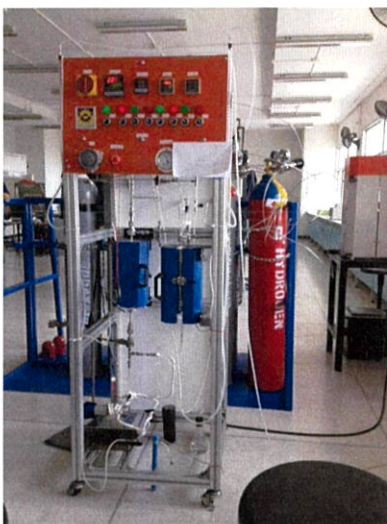
รูปที่ 3.2 ชุดเครื่องปฏิกรณ์แบบเบดนิ่ง (Fixed-bed reactor)
