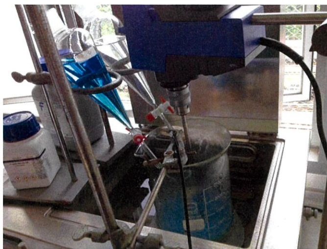
รูปที่ 3.1 แสดงการจัดอุปกรณ์เพื่อการตกตะกอน
