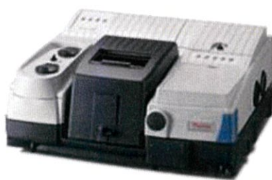
รูปที่ 3.13 แสดงภาพเครื่องฟูเรียทรานฟอร์มอินฟราเรดสเปกโทรมิเตอร์ (Fourier transform infrared- spectroscopy, FT-IR) [32]
