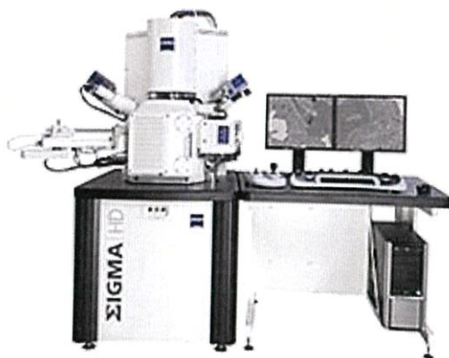
รูปที่ 3.9 แสดงภาพกล้องจุลทรรศน์อิเล็กตรอนแบบส่องกราด (scanning electron microscope, SEM) [30]
