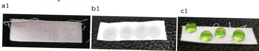
รูปที่ 2.32 แสดงพื้นผิววัสดุตัวกรองที่ทำจากผ้าฝ้าย a1) หลังการปรับปรุงสมบัติความไม่ชอบน้ำอย่างยิ่งยวด b1) หลังการปรับปรุงสมบัติความไม่ชอบน้ำอย่างยิ่งยวด และ c1) หลังการปรับปรุงผิวให้มีสมบัติความไม่ชอบน้ำอย่างยิ่งยวด [2]
