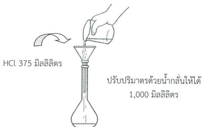
รูปที่ 21 (ข) การเตรียมสารละลายกรดไฮโดรคลอริก ความเข้มข้น 0.375 โมลาร์ (HCl 0.375 M)
