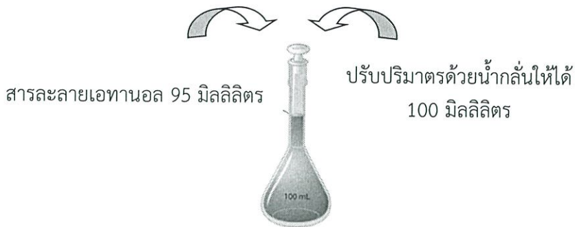
รูปที่ 24 (ข) การเตรียมสารละลายเอทานอล ความเข้มข้นร้อยละ 95
