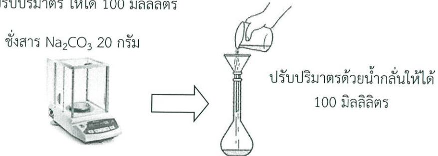
รูปที่ 9 (ข) การเตรียมสารละลายโซเดียมคาร์บอเนตความเข้มข้นร้อยละ 20 (น้ำหนักต่อปริมาตร)
