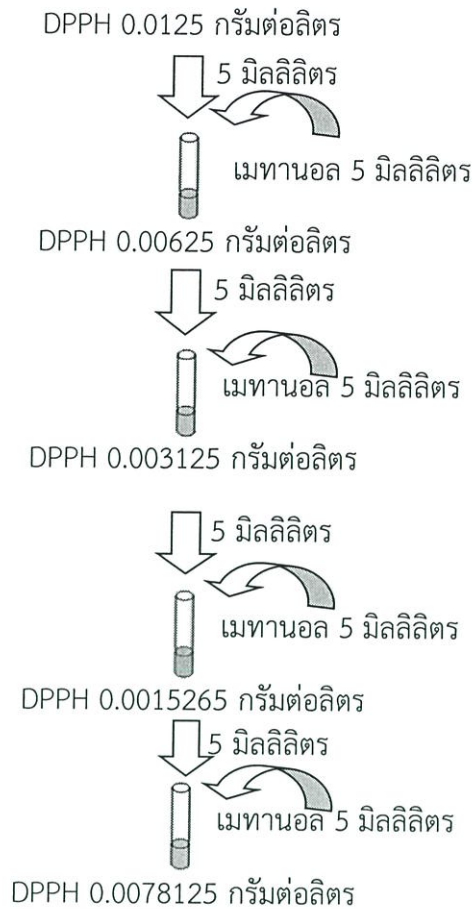
รูปที่ 4 (ข) การเตรียมสารละลายมาตรฐาน DPPH (2,2- diphenyl-1-picrylhydrazyl)
