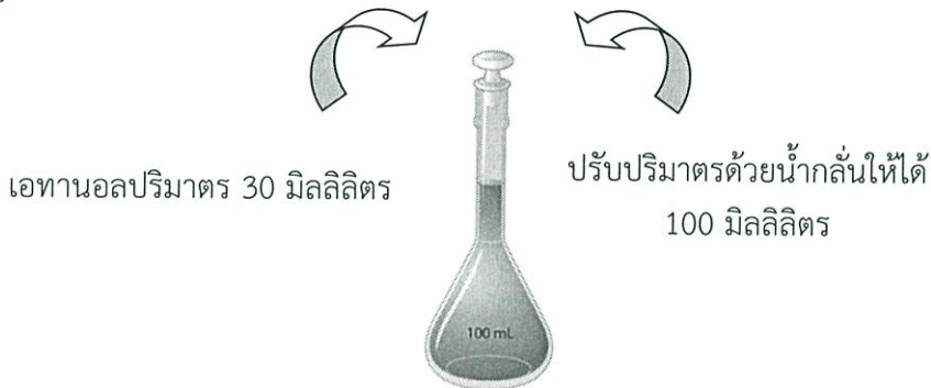
รูปที่ 1 (ข) การเตรียมสารละลายเอทานอลความเข้มข้นร้อยละ 30
