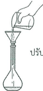
รูปที่ 7 (ข) การเตรียมสารละลายเฟอริกคลอไรด์ ( \text{FeCl}_3 \cdot 6\text{H}_2\text{O} ) ความเข้มข้น 20 มิลลิโมลาร์
