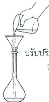
รูปที่ 25 (ข) การเตรียมสารละลายโซเดียมไฮดรอกไซด์ ความเข้มข้น 0.1 โมลาร์ (NaOH 0.1 M)
