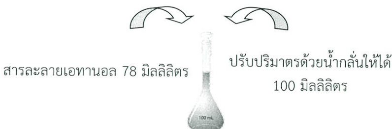
รูปที่ 23 (ข) การเตรียมสารละลายเอทานอล ความเข้มข้นร้อยละ 78
