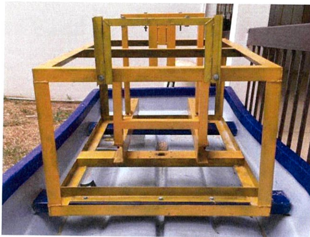
รูปที่ 3.25 ภาพถ่ายโครงสร้างหลักระบบทำน้ำจืดจากน้ำทะเลโดยใช้พลังงานคลื่น (ด้านหน้า)
