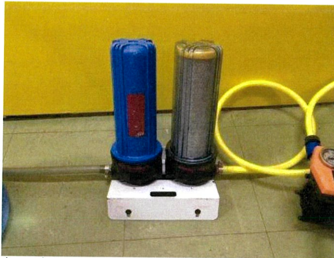
รูปที่ 3.2 เยื่อกรอง Carbon In Filter (ซ้าย) และ Micro Filtration (ขวา)
