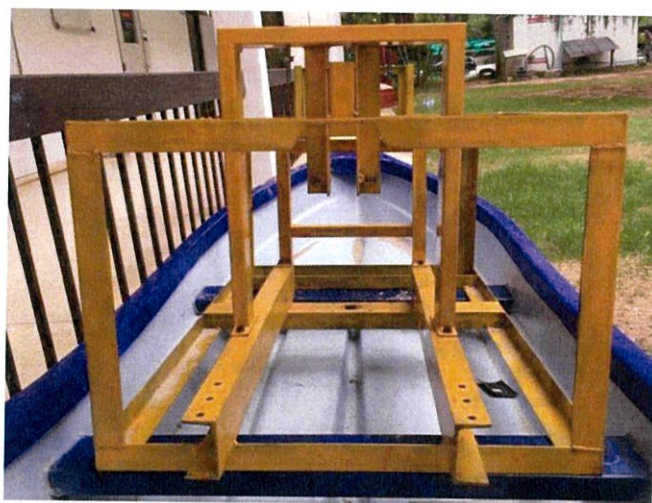
รูปที่ 3.26 ภาพถ่ายโครงสร้างหลักระบบทำน้ำจืดจากน้ำทะเลโดยใช้พลังงานคลื่น (ด้านหลัง)
