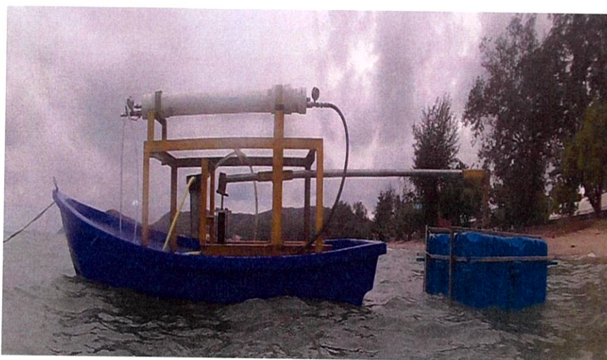
รูปที่ 3.37 ภาพถ่ายรวมทั้งระบบทำน้ำจืดจากน้ำทะเลโดยใช้พลังงานคลื่นสมุทรในสถานที่ทดสอบภาคสนาม
