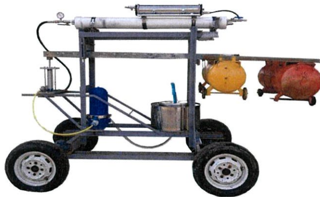
รูปที่ 1.1 ต้นแบบระบบทำน้ำจืดจากน้ำทะเลโดยใช้พลังงานคลื่น
