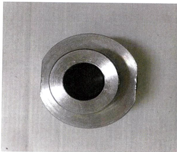
รูปที่ 3.14 ภาพถ่ายของฝาระบอกลูกสูบไฮโดรลิก (ด้านบน)
