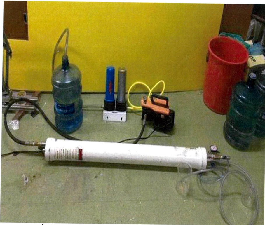
รูปที่ 4.1 ระบบการทดสอบประสิทธิภาพของเยื่อกรองรีเวอร์สออสโมซิส
