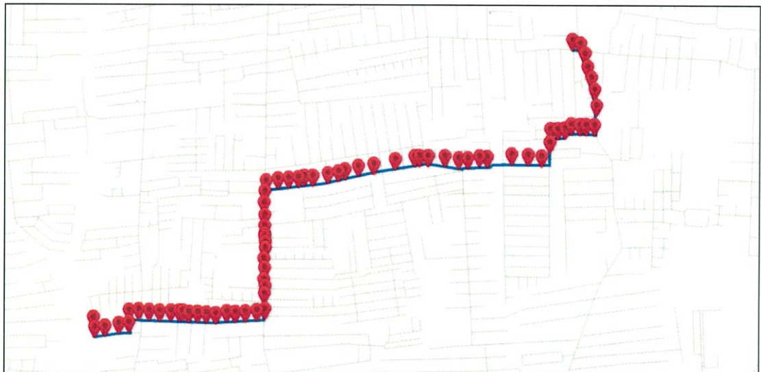
รูปที่ 3.12 GPS ที่ยังผ่านการ mapmatch แล้ว
