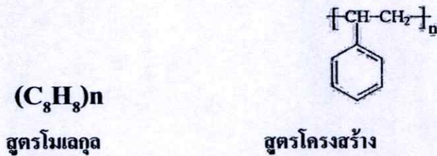
รูปที่ 2.1 สูตรโมเลกุล และ โครงสร้างของพอลิสไตรีน
