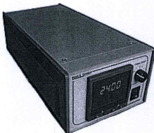
รูปที่ 3.4 ชุดควบคุมการระเหยสารของระบบระเหยสารอินทรีย์
