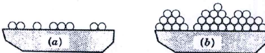
รูปที่ 2.11 แผนภาพแสดงลักษณะการดูดซับแบบ (a) monolayer adsorption และ (b) multilayer adsorption [28]
