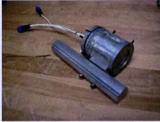
รูปที่ 3.8 แสดงหัววัดที่ใช้ในเครื่องวัดปริมาณความหนาของฝุ่นละอองในอากาศที่สร้างขึ้น
