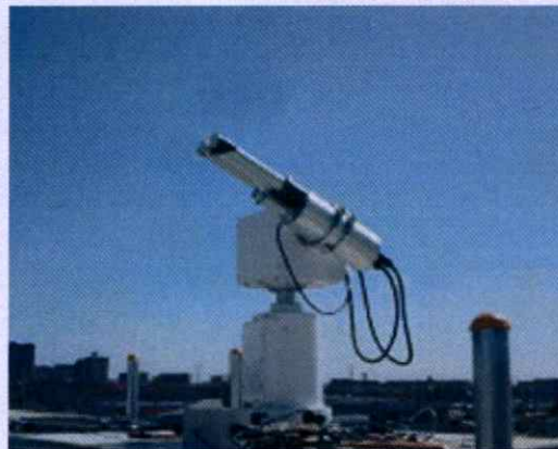
รูปที่ 4.3 แสดงหนึ่งในเครื่องวัดปริมาณความหนาของฝุ่นละอองในอากาศที่สถานที่ทำวิจัย
