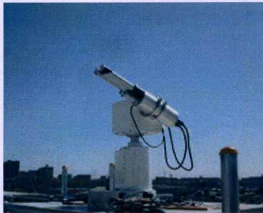
รูปที่ 3.7 แสดงเครื่องวัดปริมาณความหนาของฝุ่นละอองในอากาศที่ใช้ในงานวิจัย
