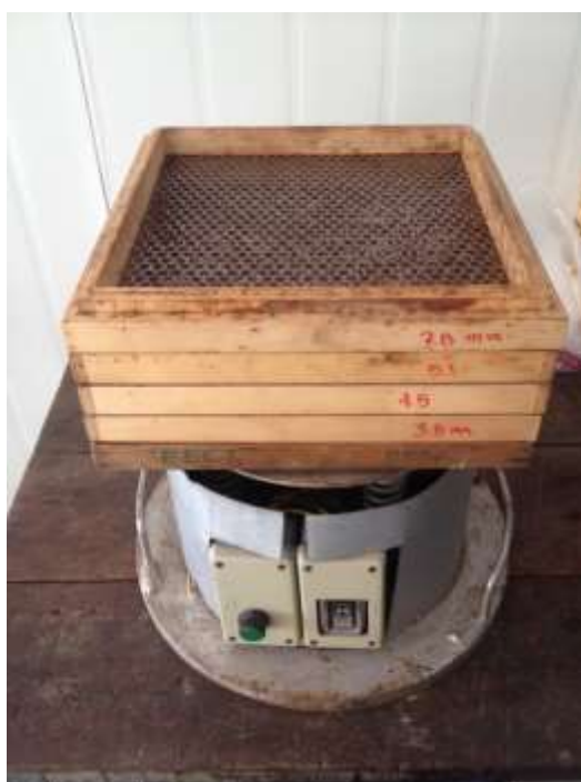
รูปที่ 4.7 การทดสอบตะแกรงที่ได้วางเป็นชั้นบนเครื่องเขย่า
