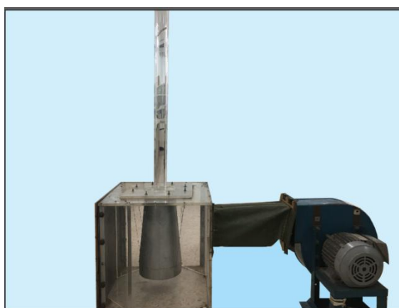
รูปที่ 3.6 ชุดทดลองหาค่าความเร็วลมสุดท้าย
