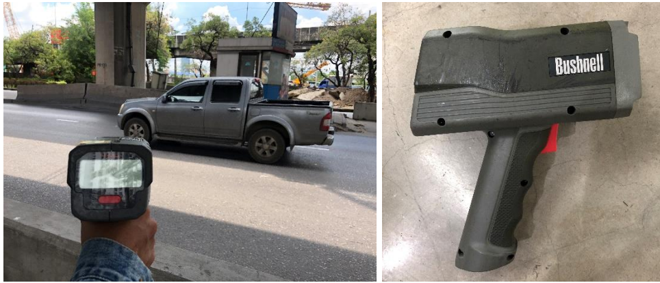
รูปที่ 3.7 : การใช้อุปกรณ์ Radar Speed Gun ตรวจสอบวัดความเร็วยานพาหนะ
