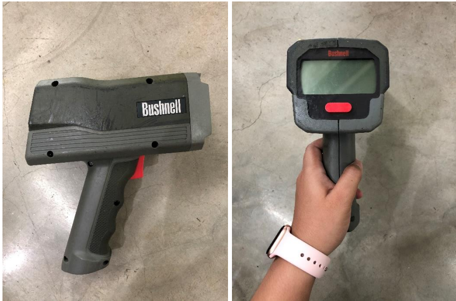
รูปที่ ข2 : “เรดาร์ กั้น” อุปกรณ์ในการสำรวจและเก็บข้อมูลความเร็ว
