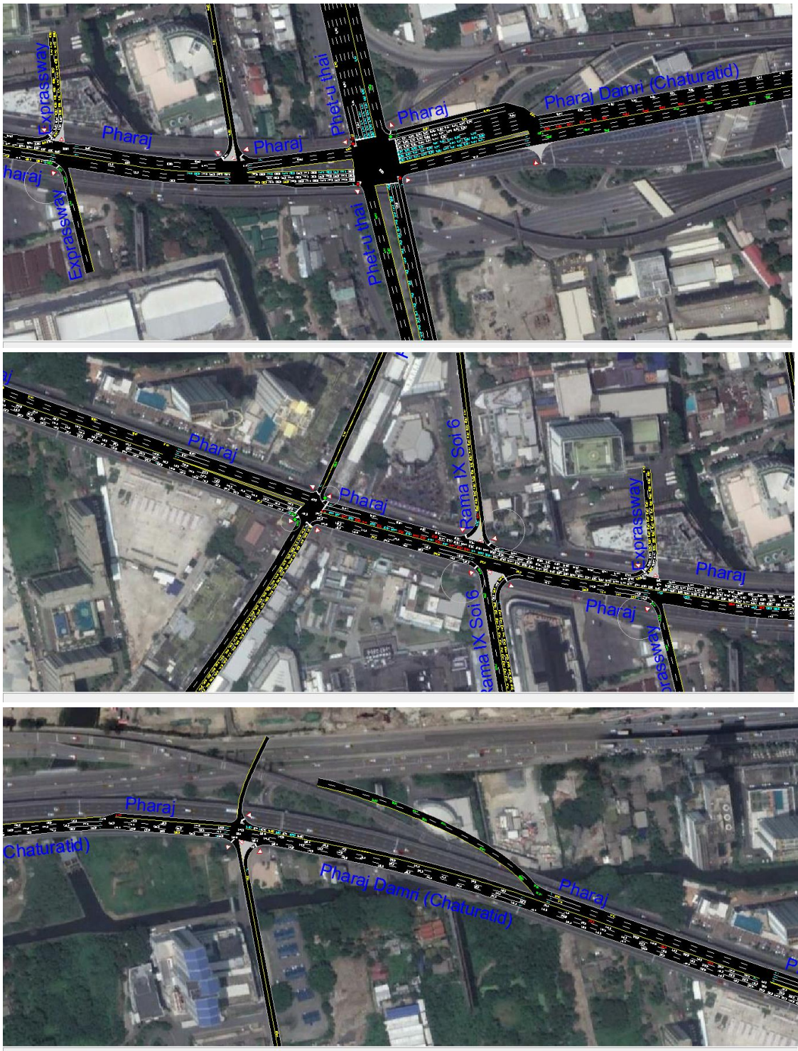
รูปที่ ก6 (ต่อ) : การประมวลผลแบบจำลองสภาพจราจรในรูปแบบสองมิติด้วยโปรแกรม Synchro
