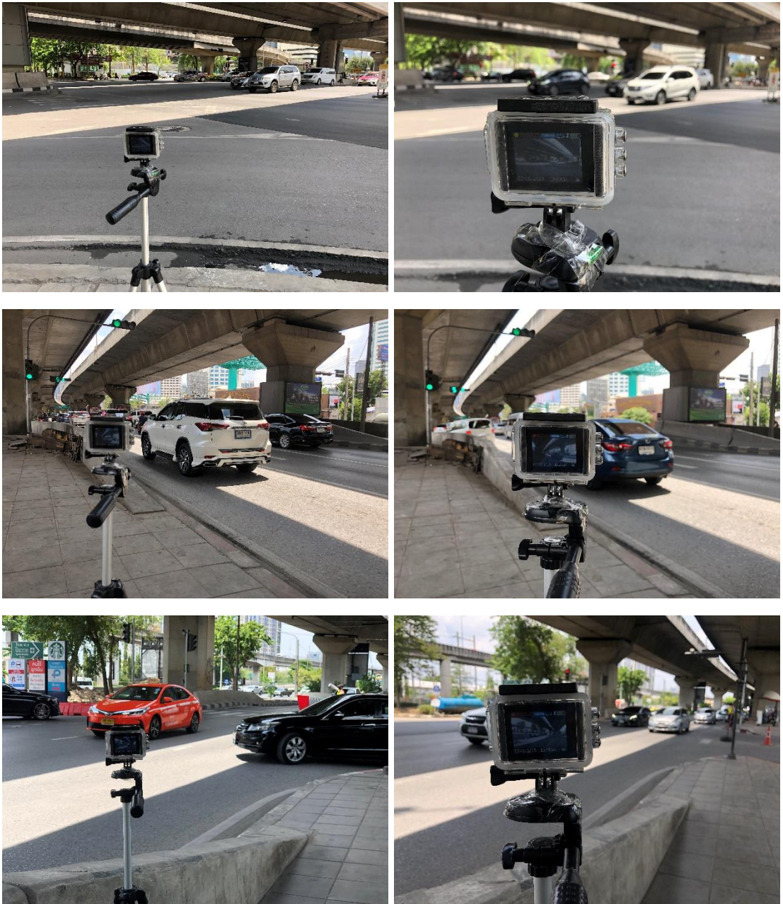
รูปที่ ข1 : “กล้องวิดีโอ” อุปกรณ์ในการสำรวจและเก็บข้อมูลปริมาณจราจร
