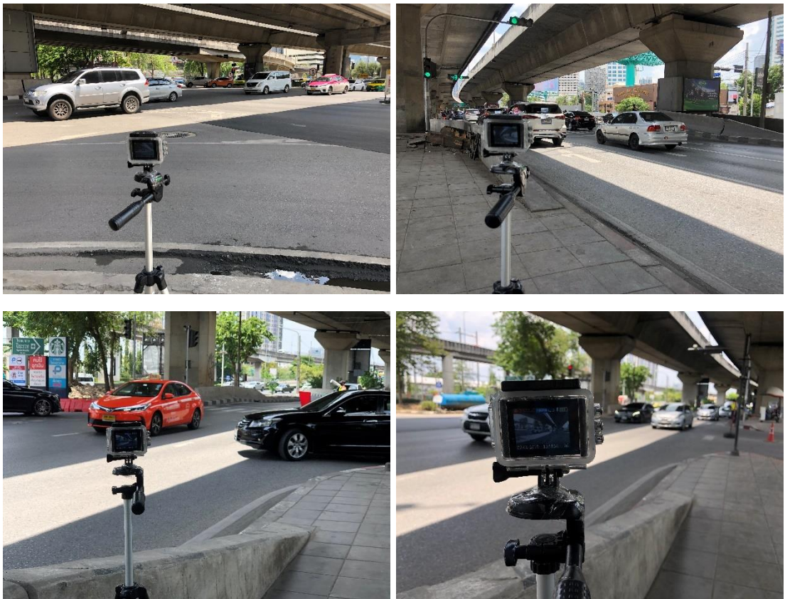
รูปที่ 3.6 : การเก็บปริมาณจราจรโดยใช้วิธีการตั้งกล้อง
