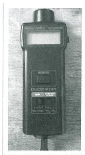
เครื่องมือวัดความเร็วรอบมอเตอร์ Digicon DT-250 TP
