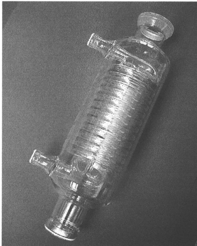
รูปที่ 3.22 อุปกรณ์แลกเปลี่ยนความร้อนแบบขวดท่อแก้ว
