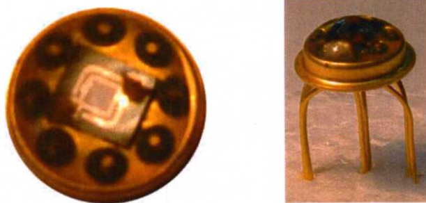
รูปที่ 3.21 ภาพถ่ายตัวตรวจับรังสีเอ็กซ์แบบซิลิคอน โฟโตไดโอดชนิด PIN ที่ถูกบรรจุบนตัวถังแบบ ครอบป้องกันโลหะ
