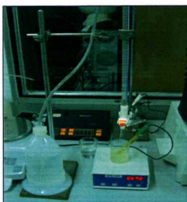
ภาพที่ 3.14 การวัดหาความเป็นกรดของน้ำส้มโอ
