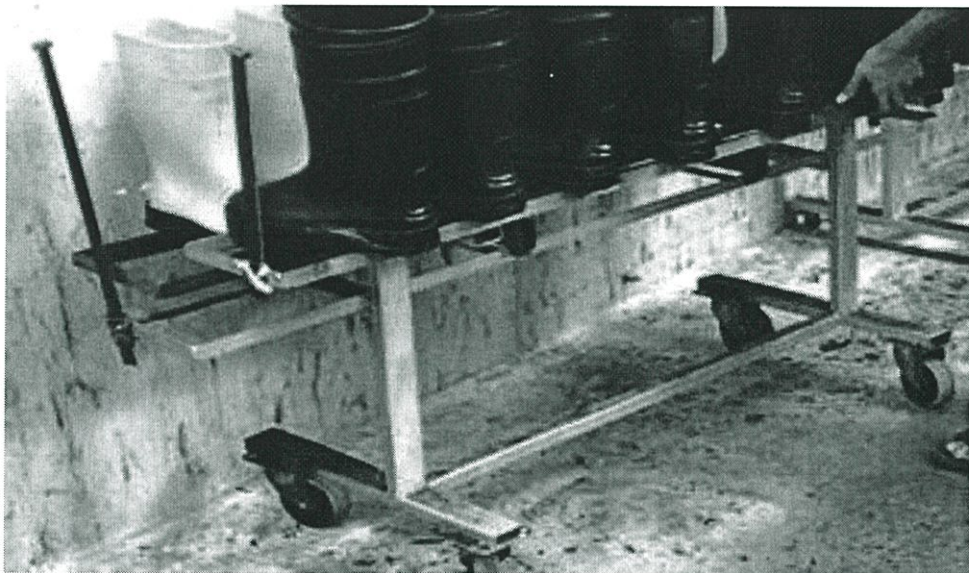
รูปที่ 4.2 รถเข็นสำหรับเคลื่อนย้ายรองเท้าบูทในแผนกฟั่นสีรองเท้าบูท (หลังปรับปรุง)
