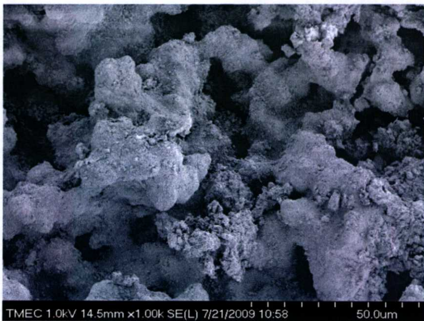
รูปที่ 4.64 แสดงโครงสร้างผลึกซีเมนต์เฟลต์ด้วยกล้อง SEM ที่กำลังขยาย 1000 เท่า W/C 0.50 โดยผสม สารเร่งการก่อตัว 0.05 % บ่มที่อุณหภูมิ 60 องศาเซลเซียสในช่วงต้น
