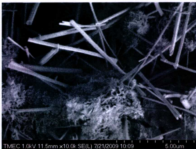
รูปที่ 4. 78 แสดงโครงสร้างผลึกคอนกรีต ด้วยกล้อง SEM ที่กำลังขยาย 10,000 เท่า W/C 0.60 โดยผสม สารเร่งการก่อตัว 0.03 %
