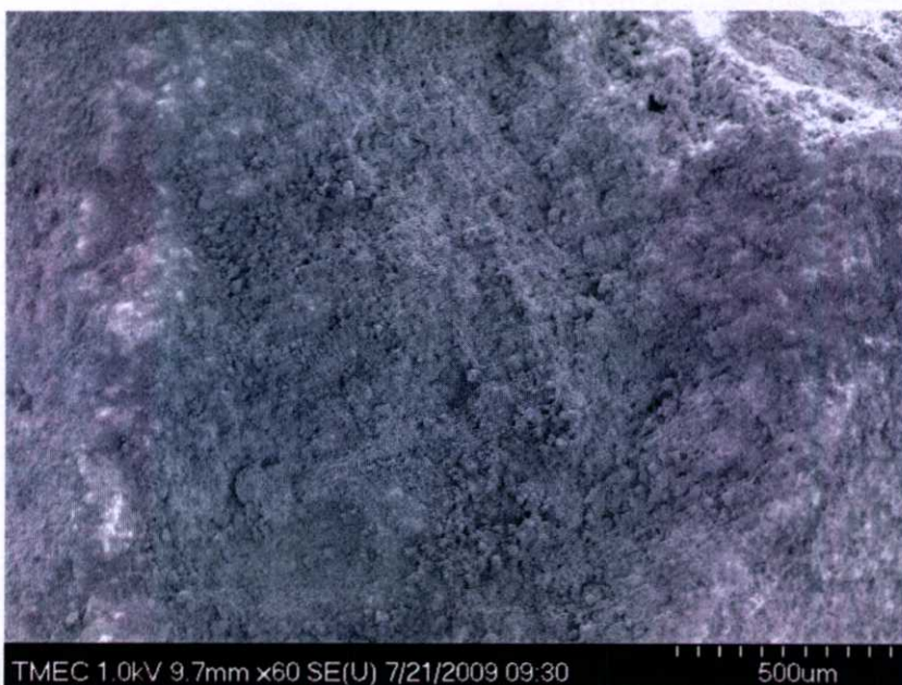
รูปที่ 4. 68 แสดงโครงสร้างผลึกซีเมนต์เฟลด์ด้วยกล้อง SEM ที่กำลังขยาย 60 เท่า W/C 0.40 โดยผสม สารหน่วงการก่อตัว 0.05 % บ่มที่อุณหภูมิ 40 องศาเซลเซียสในช่วงต้น
