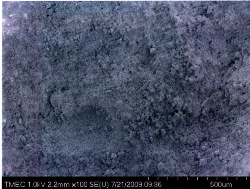
รูปที่ 4. 69 แสดงโครงสร้างผลึกซีเมนต์เฟลส์ด้วยกล้อง SEM ที่กำลังขยาย 100 เท่า W/C 0.40 โดยผสม สารหน่วงการก่อตัว 0.05 % บ่มที่อุณหภูมิ 40 องศาเซลเซียสในช่วงต้น
