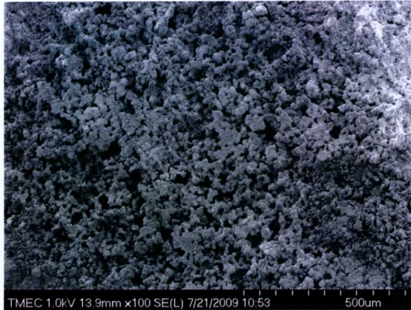
รูปที่ 4.63 แสดงโครงสร้างผลึกซีเมนต์เฟลต์ด้วยกล้อง SEM ที่กำลังขยาย 100 เท่า W/C 0.50 โดยผสม สารเร่งการก่อตัว 0.05 % บ่มที่อุณหภูมิ 60 องศาเซลเซียสในช่วงต้น
