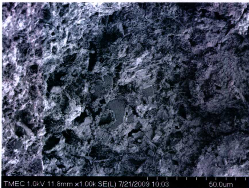
รูปที่ 4. 76 แสดงโครงสร้างผลึกซีเมนต์เฟลด์ด้วยกล้อง SEM ที่กำลังขยาย 1000 เท่า W/C 0.60 โดยผสม สารหน่วงการก่อตัว 0.05 % บ่มที่อุณหภูมิ 40 องศาเซลเซียสในช่วงต้น
