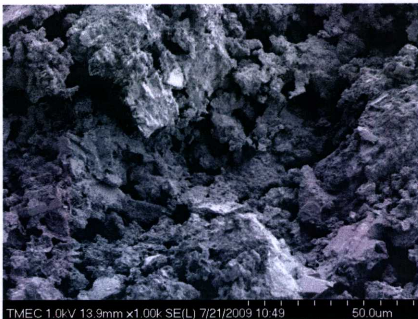
รูปที่ 4. 67 แสดงโครงสร้างผลึกซีเมนต์เฟลด์ด้วยกล้อง SEM ที่กำลังขยาย 1000 เท่า W/C 0.60 โดยผสม สารเร่งการก่อตัว 0.05 % บ่มที่อุณหภูมิ 40 องศาเซลเซียสในช่วงต้น
