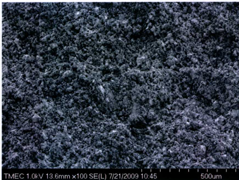
รูปที่ 4.66 แสดงโครงสร้างผลึกซีเมนต์เฟลด์ด้วยกล้อง SEM ที่กำลังขยาย 100 เท่า W/C 0.60 โดยผสม สารเร่งการก่อตัว 0.05 % บ่มที่อุณหภูมิ 40 องศาเซลเซียสในช่วงต้น
