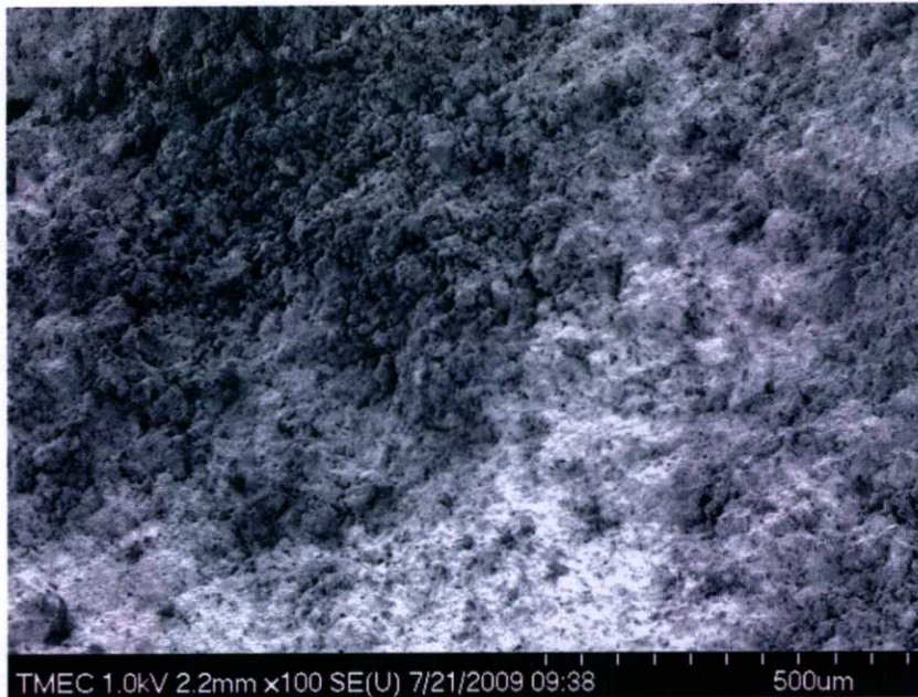
รูปที่ 4. 71 แสดงโครงสร้างผลึกซีเมนต์เฟลด์ด้วยกล้อง SEM ที่กำลังขยาย 1000 เท่า W/C 0.50 โดยผสม สารหน่วงการก่อตัว 0.05 % บ่มที่อุณหภูมิ 40 องศาเซลเซียสในช่วงต้น
