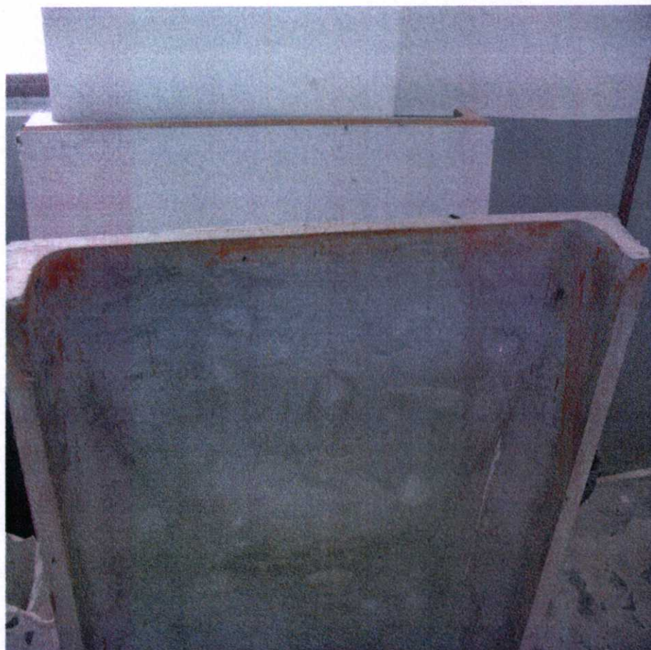
รูปที่ 4. 83 แสดงแผ่นสำเร็จเมื่อผสมสารลดน้ำในปริมาณที่เหมาะสม
