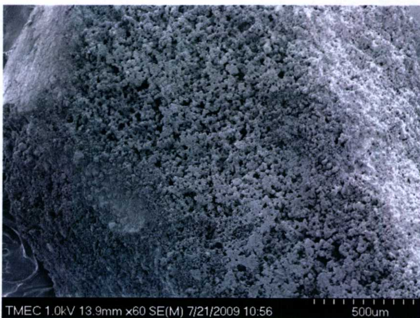
รูปที่ 4.62 แสดงโครงสร้างผลึกซีเมนต์เฟลด์ด้วยกล้อง SEM ที่กำลังขยาย 60 เท่า W/C 0.50 โดยผสม สารเร่งการก่อตัว 0.05 % บ่มที่อุณหภูมิ 60 องศาเซลเซียสในช่วงต้น
