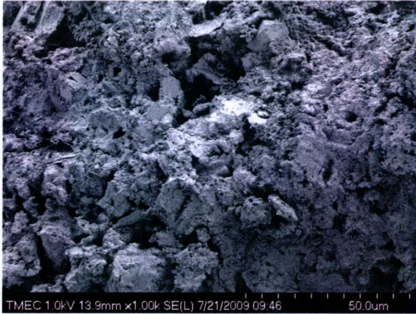
รูปที่ 4. 73 แสดงโครงสร้างผลึกซีเมนต์เฟลด์ด้วยกล้อง SEM ที่กำลังขยาย 1000 เท่า W/C 0.50 โดยผสม สารหน่วงการก่อตัว 0.05 % บ่มที่อุณหภูมิ 40 องศาเซลเซียสในช่วงต้น
