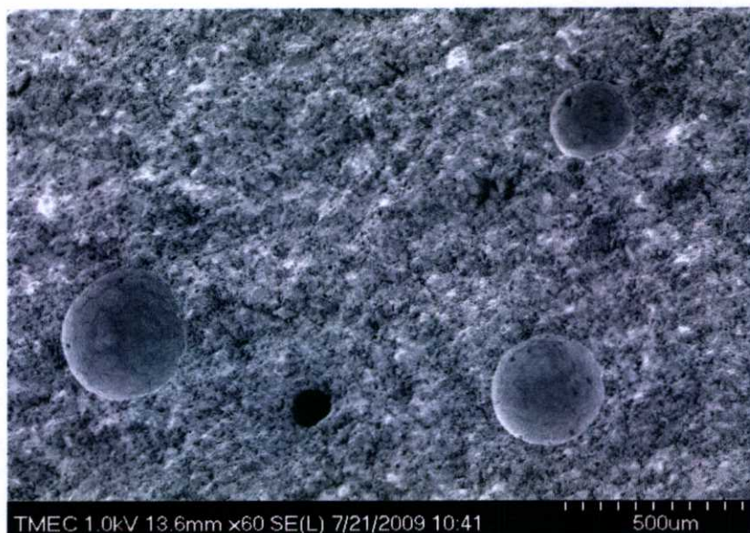
รูปที่ 4.59 แสดงโครงสร้างผลึกซีเมนต์เฟลสท์ด้วยกล้อง SEM ที่กำลังขยาย 60 เท่า W/C 0.40 โดย ผสม สารเร่งการก่อตัว 0.05 % บ่มที่อุณหภูมิ 40 องศาเซลเซียสในช่วงต้น
