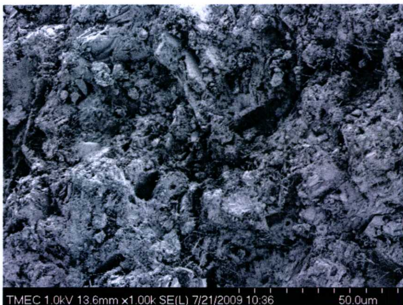
รูปที่ 4.61 แสดงโครงสร้างผลึกซีเมนต์เฟลด์ด้วยกล้อง SEM ที่กำลังขยาย 1000 เท่า W/C 0.40 โดยผสม สารเร่งการก่อตัว 0.05 % บ่มที่อุณหภูมิ 40 องศาเซลเซียสในช่วงต้น
