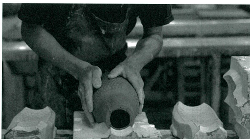
ภาพที่ 2.9 แสดงการขึ้นรูปด้วยการหล่อ (Casting)
