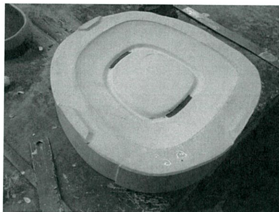
ภาพที่ 4.4 แสดงการทำแม่พิมพ์หล่อตัน
