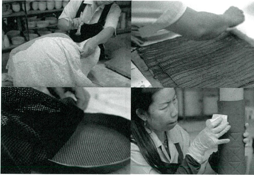
ภาพที่ 2.10 แสดงการตกแต่งชิ้นงานด้วยการปั๊ม (Stamping) ที่มา: แฟ้มภาพ นางสาวมนัสวี มีทรัพย์
