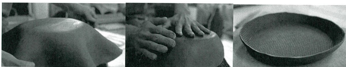
ภาพที่ 2.7 แสดงการขึ้นรูปโดยต้นแบบปูนปลาสเตอร์ ที่มา: แฟ้มภาพ นางสาวนัสวี มีทรัพย์
