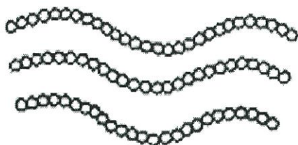
รูปที่ 2.1 โครงสร้างพอลิเมอร์แบบเส้น (Chain Length Polymer) [3]
