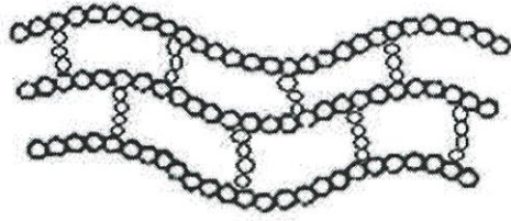
รูปที่ 2.3 โครงสร้างพอลิเมอร์พอลิเมอร์แบบร่างแห (Cross - linking Polymer) [3]
