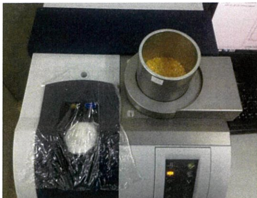
รูปที่ ข.1 FT-NIR spectrometer (MPA, Bruker, germany)
