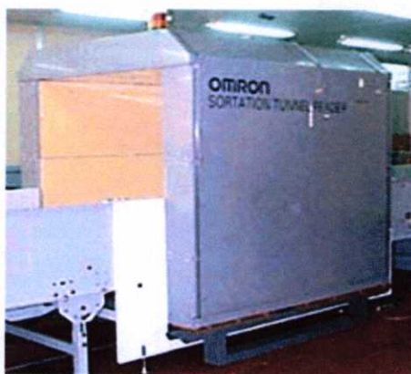
รูปที่ 2.12 แสดงตัวอ่านข้อมูล Readerแบบอุตสาหกรรม (Industry Reader)
