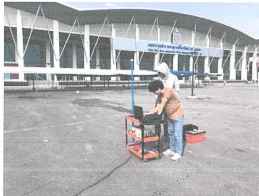
รูปที่ 3.19 การทดสอบสถานีจลน์
