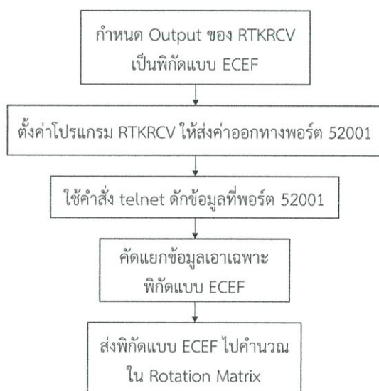
รูปที่ 3.9 การนำพิกัดจากโปรแกรม RTKRCV ไปคำนวณใน Rotation Matrix
