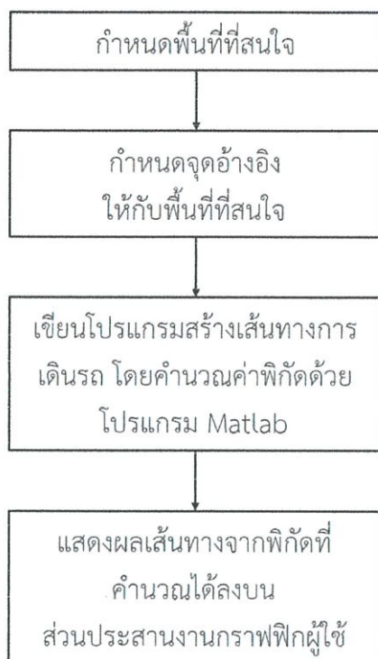
รูปที่ 3.12 ขั้นตอนการสร้างเส้นทางการเดินรถในพื้นที่ที่สนใจ
