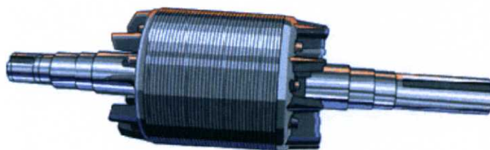
รูปที่ 2.2 โรเตอร์ของเครื่องจักรไฟฟ้าเหนี่ยวนำแบบกรงกระรอก
