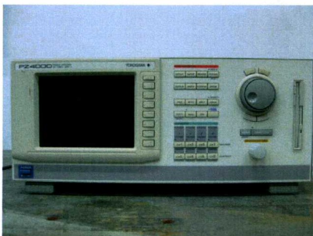
รูปที่ 4.5 เครื่องมือวัดทางไฟฟ้า (Yokogawa รุ่น PZ-4000)
