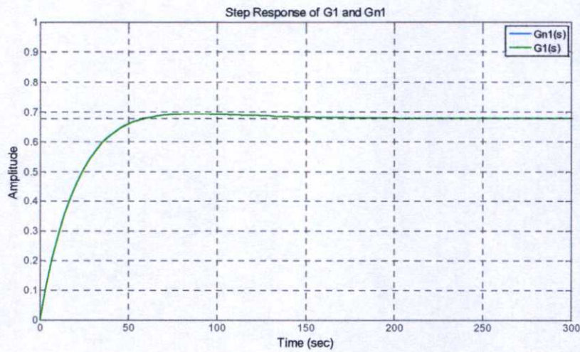
รูปที่ 5.5 แสดงการเปรียบเทียบของผลตอบสนองแบบขั้นบันไดระหว่าง G_1(s) และ G_{n1}(s)
