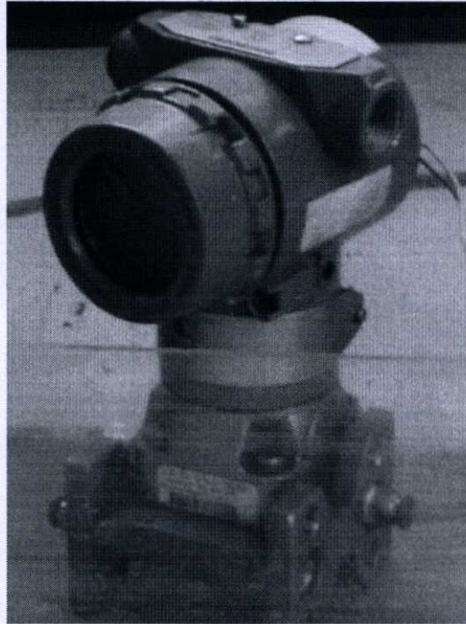
รูปที่ ก.5 อุปกรณ์วัดระดับน้ำ ( Differential Pressure Transmitter )
