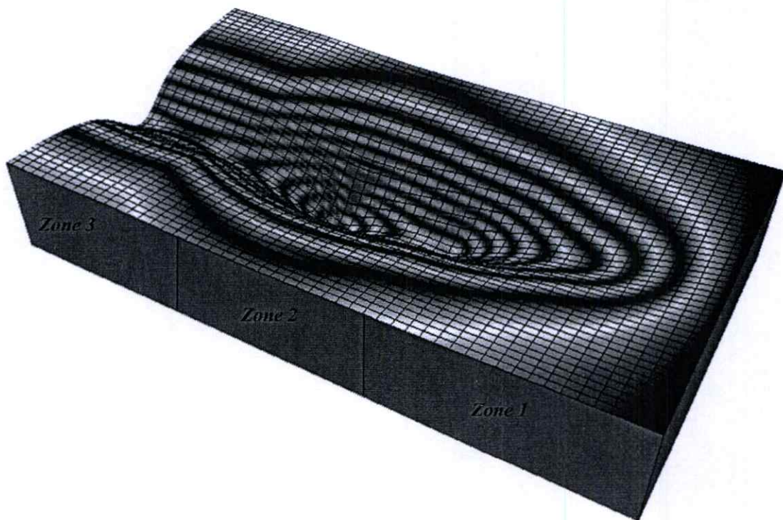
รูปที่ 6.41 พื้นผิวแบบ 3 มิติแสดงร่องการทรุดตัวที่เกิดขึ้นในแต่ละโซน
